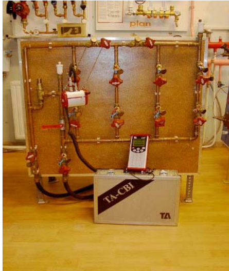
Fűtéstechnikai laboratórium, fűtési rendszerek hidraulikai besabályozásának vizsgálata
